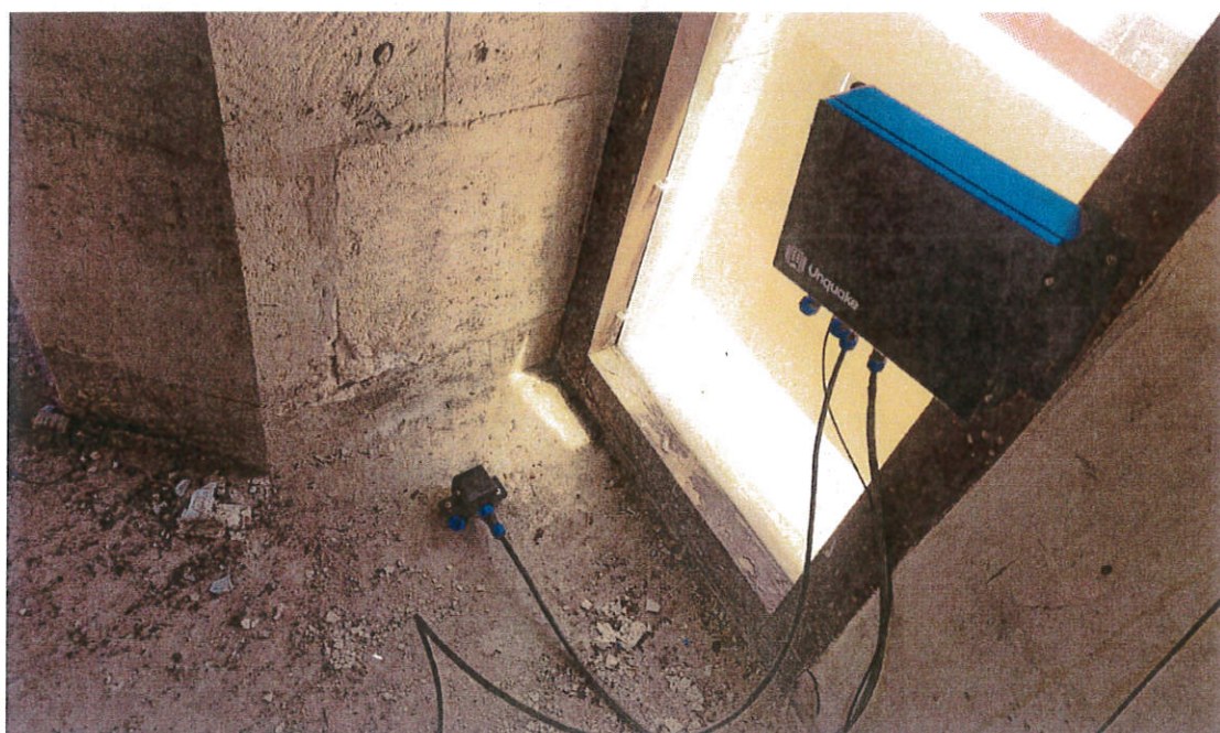
Εικόνα 8. Μόνιμος επιταχυνσιογράφος με το επιταχυνσιόμετρο να εδράζεται στην πλάκα δαπέδου στο επίπεδο ρολογιού.
